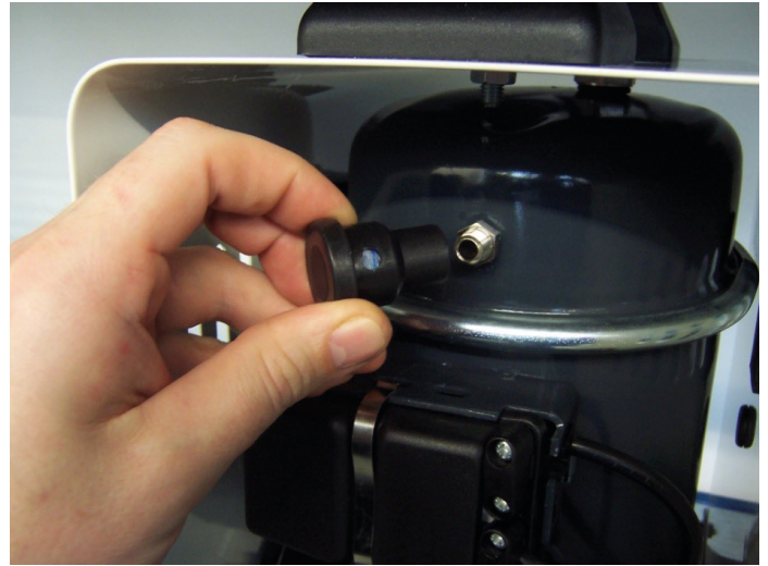
Rote Kappe durch Luftfilter ersetzen.
